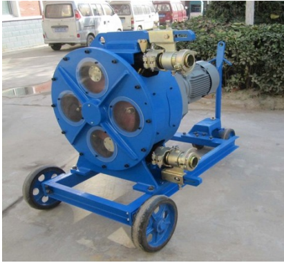
Bơm ống cho bê tông bột
