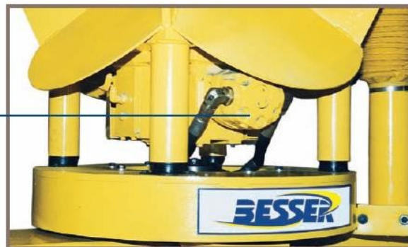
Đầu rung thủy lực theo phương thẳng đứng nén chặt bê tông nhờ tính hiệu quả của tác động rung việc dùng đầu rung này còn làm giảm thời gian tạo miệng loe và chi phí bảo trì.
