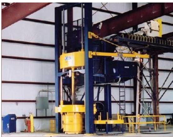
Hình ảnh bên hông một máy model A-60 Advantage cho thấy khung máy cấu hình ba chân độc đáo. Cấu hình này cho phép cấp liệu vào phễu chứa bê tông từ phía sau (như ở máy này) hoặc từ hai bên
