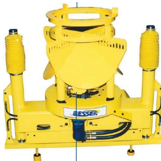
Thiết bị tạo miệng loe bằng thủy lực có bàn quay rung thay thế nhanh cho phép sản xuất công chất lượng cao và hiệu quả. Lớp vỏ bọc bao phủ các trục dẫn hướng giữ cho hệ thống dẫn hướng không bị dính vật liệu làm bẩn.
