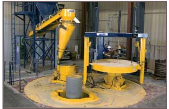
M á y T r i - C a s t c ó 3 t r m c h o p h é p c p l i u , q u a y u é p v à t h á o k h u ô n n g t h i .
