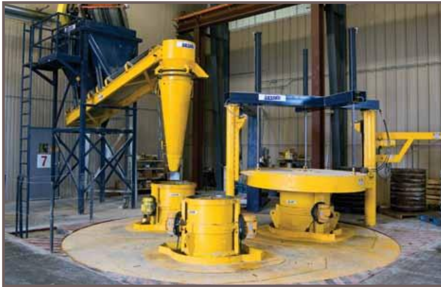
Máy Tri-Cast có tính linh hoạt rất cao trong việc sản xuất sản phẩm bê tông có hoặc không có cốt thép. Có thể bổ sung thêm một trạm rung ép cho phép sản xuất sản phẩm có kích thước lớn hơn 1800mm.
